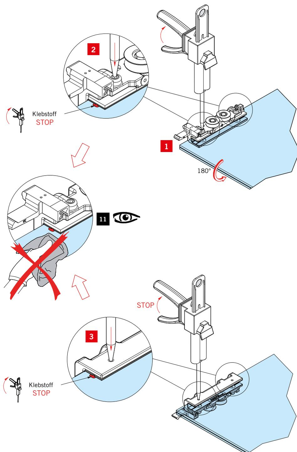
Der Klebevorgang nach der Fixierung des Klemmlaufwagens ist denkbar einfach:
